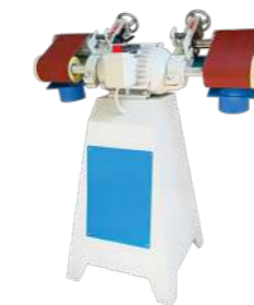
MÁY CHÀ NHÁM TRỤC MÚT DOUBLE SHAFT SIMPLE SPONGE SANDING
